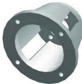
蜗轮丝杠升降机应用范围广泛，因而在特定的情况下需要直接将电机与升降单元连接。在待连接的两驱动元件尺寸和重量相差不是很大的情况下，电机可以通过IEC法兰和弹性联轴器直接连接于升降机。
