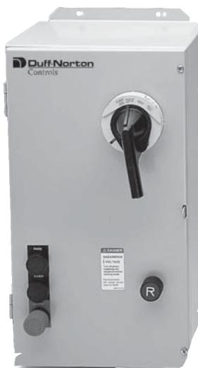
Duff-Norton 持续运行交流电机控制器专为不需监控其操作过程的系统而设计，要启动系统，操作人员必须按下按钮。系统将持续运行直到行程终点的限位开关被触发。操作人员可在任何时候通过按下停止按钮来停止运行。
