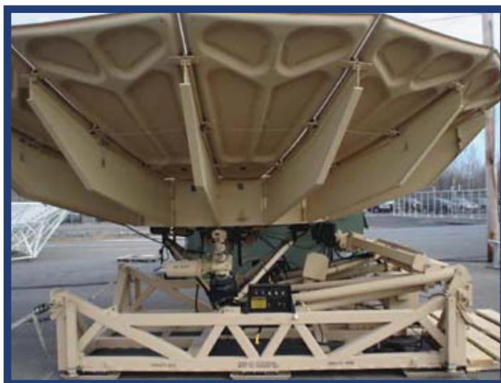
消隙型螺旋升降机经常用于卫星天线在 X,Y 和 Z 轴方向的跟踪，确保天线的工作性能以防止大风等所造成的偏航。
