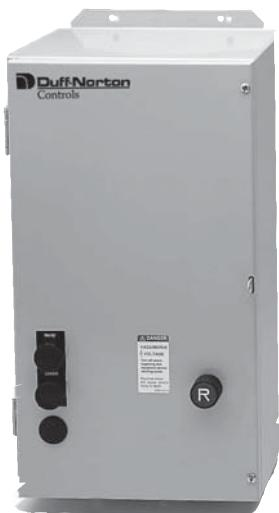
Duff-Norton 慢速点动交流电机控制器提供简单可靠的操作。操作人员必须保持向下按动按钮以激活一个方向的运动并通过释放按钮来停止运动。如果最后的行程限位开关被触发，系统会自动停止工作。
